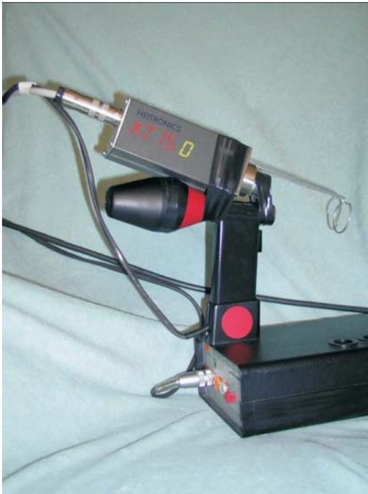
Abbildung 3 Radiometer KT 15D der Fa. Heimann-Heitronics in Verbindung mit der Infrarotlampe des Infrarot- koagulators der Fa. Nourypharma
